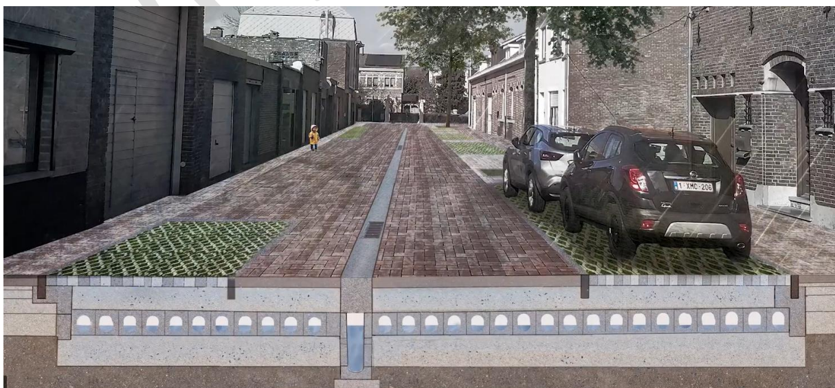
Afbeelding principe van infiltratie door middel van Fluvio-blokken in de Nonnenstraat
