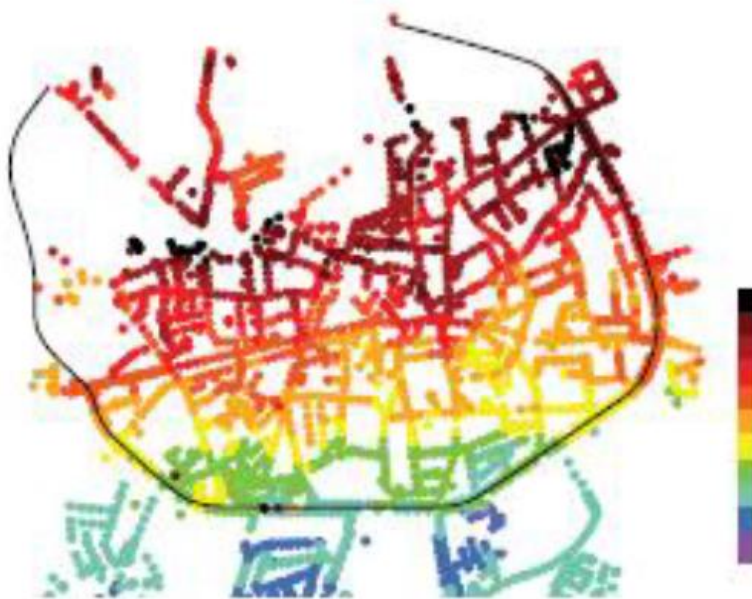
Figuur 25 Hoogtepeilen putdeksels (Bron: putdekselhoogtes – luchtfotoplan – nota alternatieven bufferbekken Hemelwateras Turnhout Oost, 2017, stad Turnhout).
