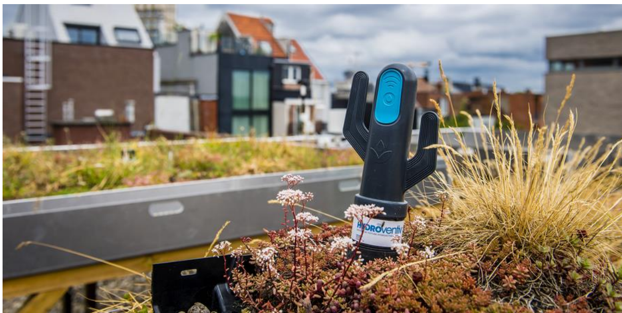
Figuur 48: Meetsensoren op een intelligent Antwerps groendak (bron: stad Antwerpen)
