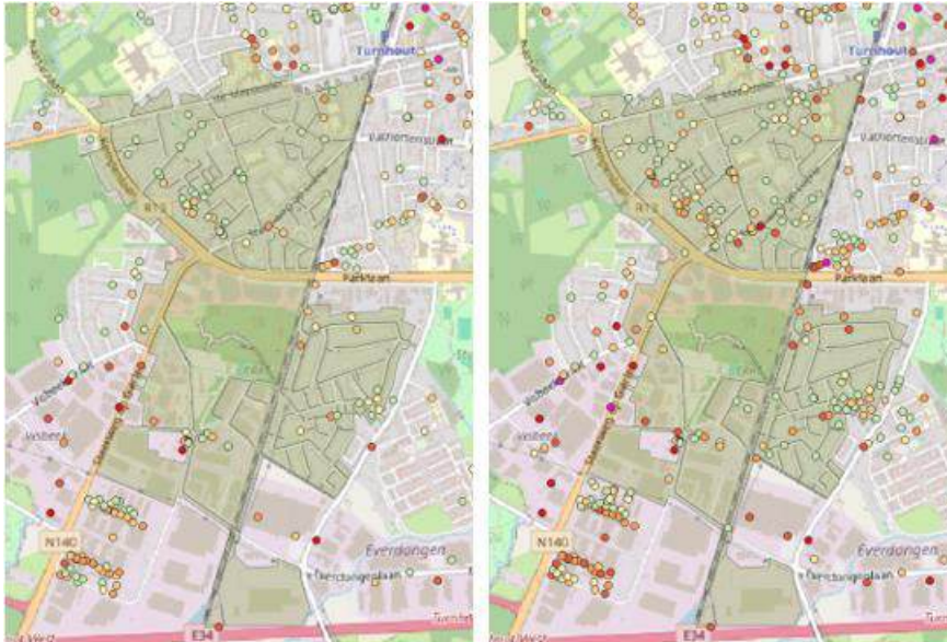
Wateroverlast bij T20 huidig klimaat zonder afkoppeling - Wateroverlast bij T20 in 2050 zonder afkoppeling
