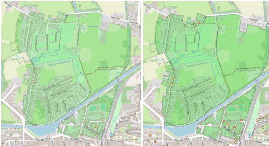
Wateroverlast bij T20 huidig klimaat zonder afkoppeling - Wateroverlast bij T20 in 2050 zonder afkoppeling
