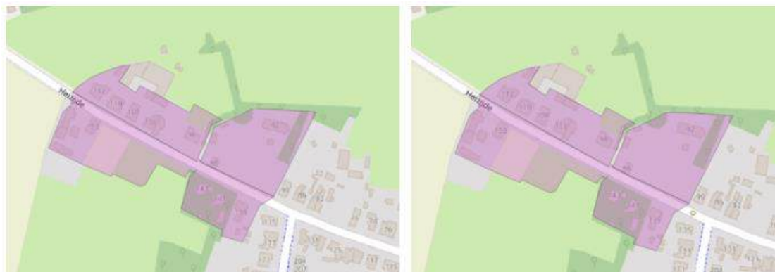
Wateroverlast bij T20 huidig klimaat zonder afkoppeling - Wateroverlast bij T20 in 2050 zonder afkoppeling
