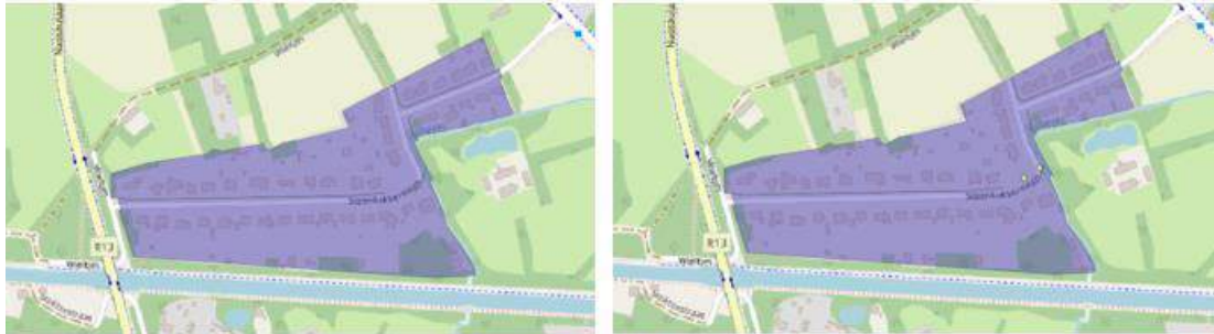
Wateroverlast bij T20 huidig klimaat zonder afkoppeling - Wateroverlast bij T20 in 2050 zonder afkoppeling
