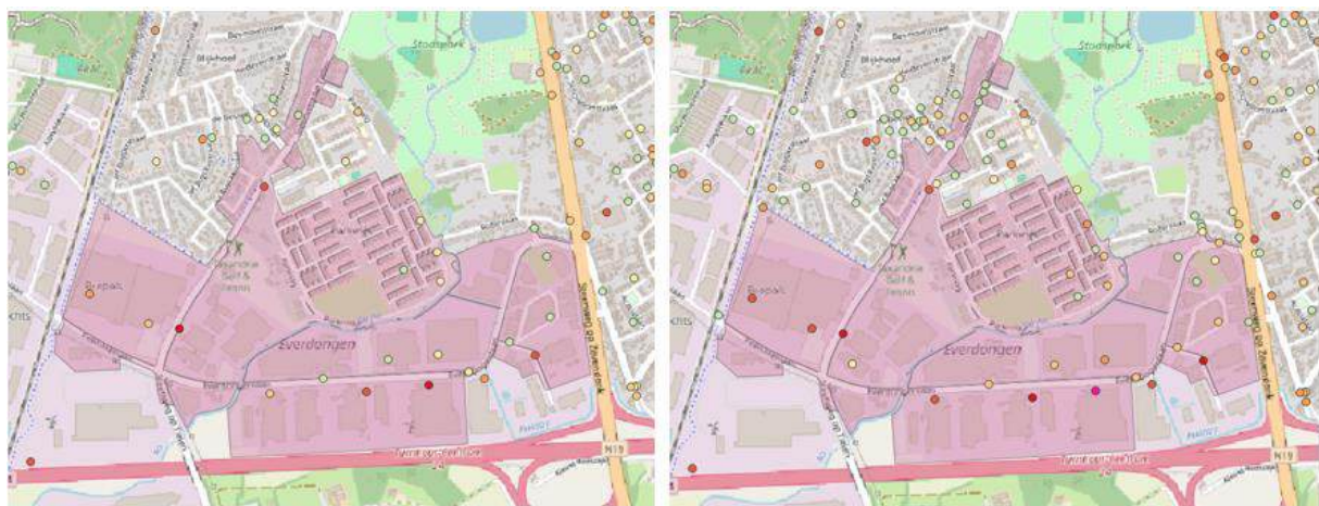
Wateroverlast bij T20 huidig klimaat zonder afkoppeling - Wateroverlast bij T20 in 2050 zonder afkoppeling
