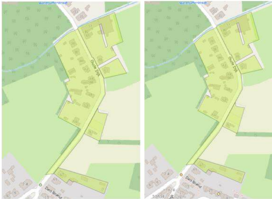
Wateroverlast bij T20 huidig klimaat zonder afkoppeling - Wateroverlast bij T20 in 2050 zonder afkoppeling
