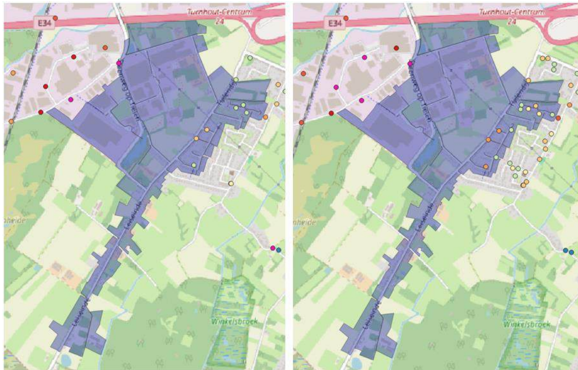
Wateroverlast bij T20 huidig klimaat zonder afkoppeling - Wateroverlast bij T20 in 2050 zonder afkoppeling
