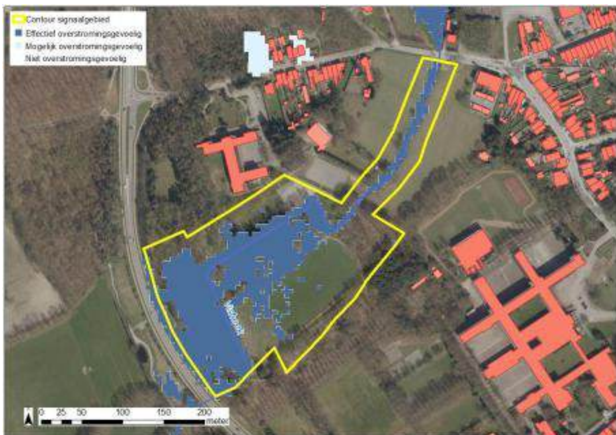
Figuur: watertoetskaart van het signaalgebied op recente overstromingsgevoelige gebieden (lichtblauw = mogelijk overstromingsgevoelig), volgens Ministerieel Besluit dd. 1/6/2014. orthofoto (medio 2015) met aanduiding van de overstromingsgevoelig; donkerblauw = effectief
