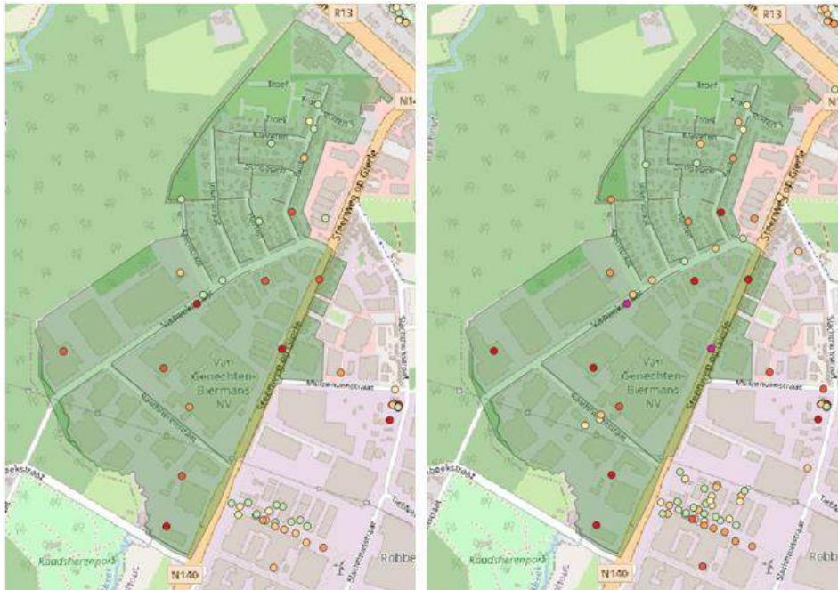
Wateroverlast bij T20 huidig klimaat zonder afkoppeling - Wateroverlast bij T20 in 2050 zonder afkoppeling
