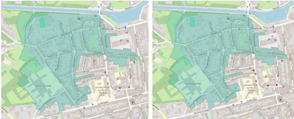
Wateroverlast bij T20 huidig klimaat zonder afkoppeling - Wateroverlast bij T20 in 2050 zonder afkoppeling
