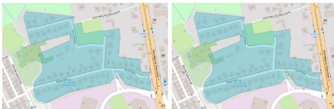
Wateroverlast bij T20 huidig klimaat zonder afkoppeling - Wateroverlast bij T20 in 2050 zonder afkoppeling
